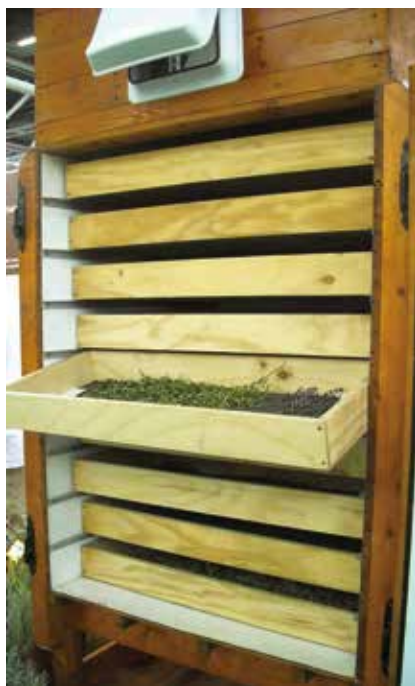
Essiccatore sperimentale a pannelli solari (ideato dal Dipartimento di Agronomia Ambientale e produzioni vegetali dell'Università degli studi di Padova)
