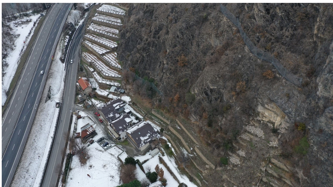
Figura 25: Foto del settore A in cui sono evidenti le opere di protezione passiva (barriere paramassi).
