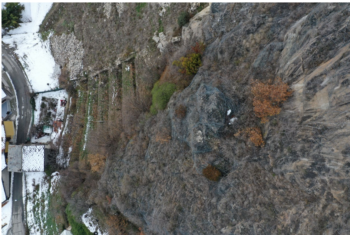
Figura 26: Foto del settore B inferiore in cui si evidenziano le opere di protezione attiva (rete metallica e pannello in fune).
