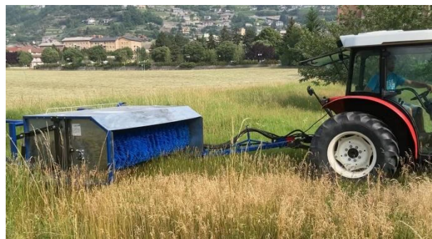
Figura 5. Prototipo di spazzolatrice per la raccolta di sementi spontanee progettato, costruito e brevettato dallo IAR.
