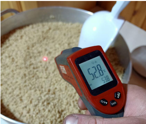
Figura 2. Misurazione della temperatura della pasta del gheriglio con pirometro.
